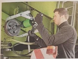
Die hydraulischen Abzieher von Kukko können auch extreme Abziehprobleme lösen.
